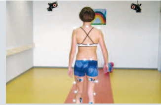
Eine Kamera verfolgt mithilfe von Infrarot-Reflektoren (Kugeln) die Bewegungen. Ein Computermodell macht den Bewegungsablauf eines Menschen sichtbar. Pfeile stellen die Kräfte dar, die der Patient auf den Boden ausübt.
